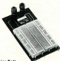
Junior-Sett Antall poler: 780. Strømskinne/poler: 8/200. Singalskinne/poler: 116/580. Laboratorie- kontakt: 4 mm Ø. Forbindelsessett: VS1. Mål: (B x H x D) 130 x 130 x 21 mm. Best.-nr. 52 74 67
